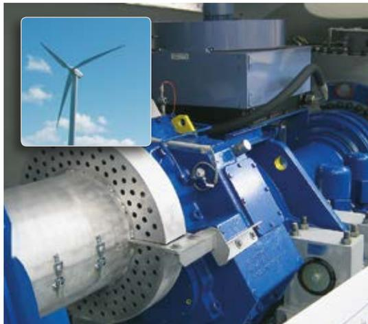
Easy-Laser® は、いろいろなサイズ・タイプの風力発電の増速機と発電機間の芯出しに活用されています。オペレーターの安全を確保するため、ローターにブレーキをかけた状態でも測定できる特殊ブラケット（オプション）を用意しています。
