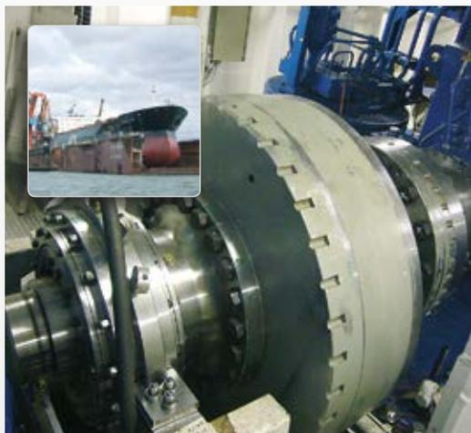
船のエンジン・ギアボックス・プロペラシャフトの芯出しにも活用されています。便利なブラケットを使用し、測定機器をシャフト・カップリング・フライホールなどの最も適した位置に固定することができます。
