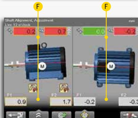
3. マシンの調整を行うと現在の数値がライブで反映されます。行った調整は水平方向と垂直方向ともに図と数字で分かりやすく表示されます。
