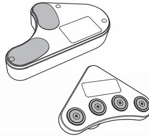
発信器・受信器ともにマグネット式基準面があり、簡単にシープに取り付けられます。非磁性シープへの取り付けの場合は、両面粘着テープまたはクランプでの取り付けが可能です。
