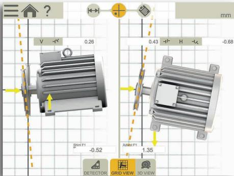
**XTシリーズで：** Easy-Laser XT アライメントアプリをダウンロードし、スマートフォンやタブレットをディスプレイユニット\*として使用可。もしくは XT11 ディスプレイユニットを使用。
